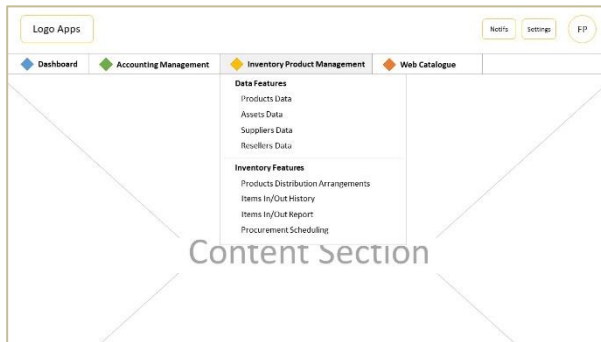
Gambar 1. Mockup User Interface dari Fitur Manajemen Persediaan Produk pada Sistem Informasi Manajemen UMKM / MISO-P
