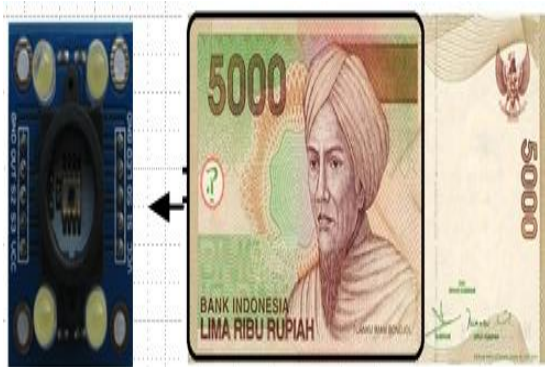
Gambar 8. Posisi uang yang dideteksi TCS3200
