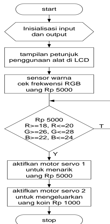
Gambar 11. Flowchart Pemrograman Vending machine Penukar Uang
