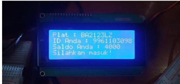
Gambar 9. Hasil Pengujian Spesifikasi 5 pada Saat Kendaraan Berhasil Masuk
