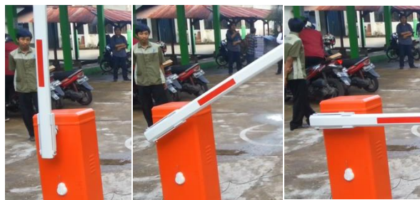
Gambar 6. Dokumentasi Uji Fungsi Gate Barrier
